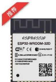
ESP32-WROOM-32D 集成 ESP32-D0WD, 功能强大, 用途广泛, 可以用于低功耗传感器网络和要求极高的任务, 例如语音编码、音频流和 MP3 解码等。
